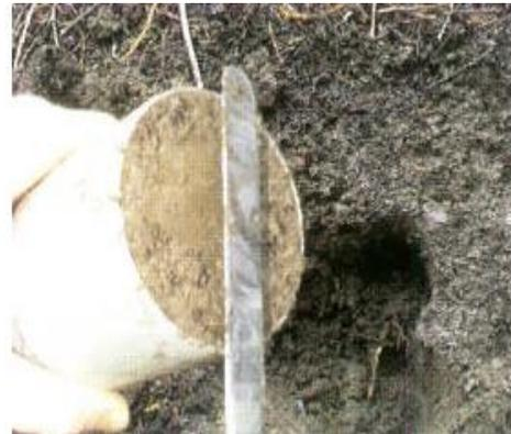
**Consideraciones:** Para suelos rocosos o gravillosos se utiliza el procedimiento descrito en la norma NC ISO 11272:2003, (Calidad del suelo. Determinación de la densidad aparente base suelo seco)
